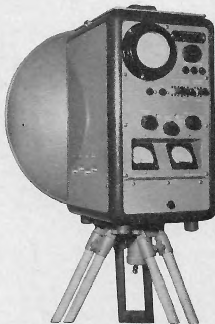
Fig. 3 - MRA 1. Stazione secondaria: pannello comandi.
