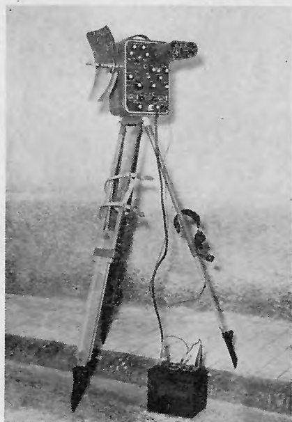
Fig. 4 - Mod. MRA 2. Stazione (principale o secondaria) in posizione di lavoro.
