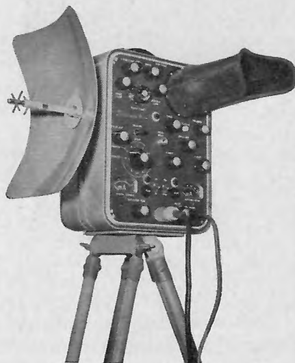
Fig. 5 - Mod. MRA 2. Stazione (primaria o secondaria): pannello comandi.
