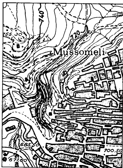
Fig. 3 - Cartografia di base a scala 1 : 5 000 ottenuta mediante rilievo aerofotogrammetrico. L'equidistanza è di 4 metri. Vi è rappresentata la periferia di un centro abitato del Nisseno con una zona limitrofa mediamente accidentata.
