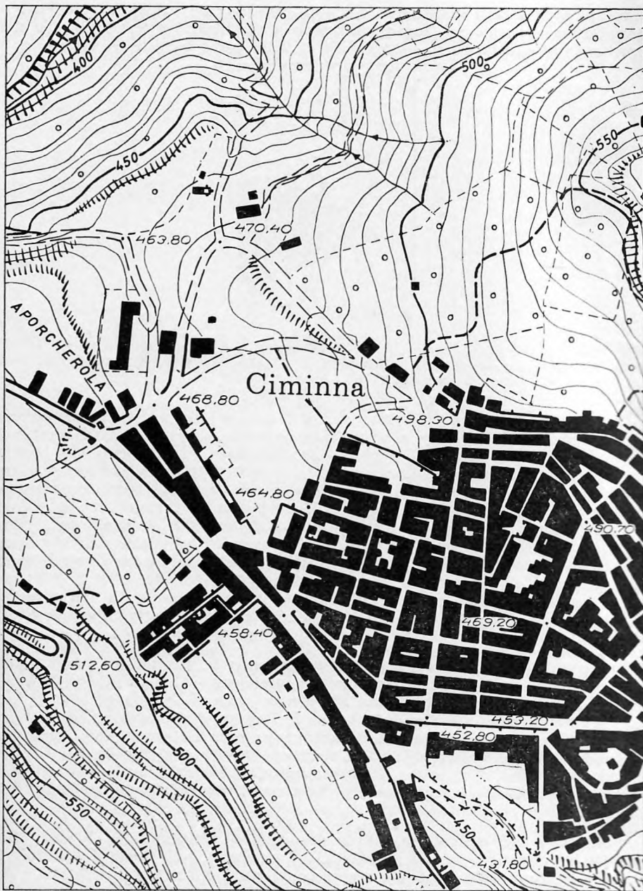
Fig. 9 - Cartografia a scala 1:5 000 rappresentante lo stesso territorio di cui alla figura 8, derivata dalla scala 1:10 000 con infittimento delle curve di livello. Equidistanza 5 m.
