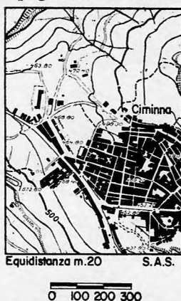
Fig. 10 - Cartografia a scala 1:20 000 ed equidistanza di 20 m. derivata fotomeccanicamente dalla cartografia di base, previo diradamento delle curve di livello.
