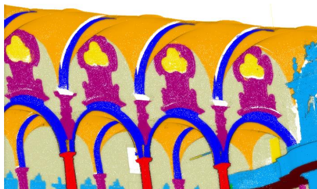
Figura 7. Interno chiesa con esempio di archi aggettanti (blu) rispetto all'altezza delle volte (arancione).
