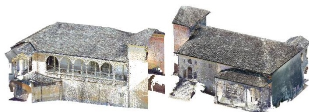
Figura 2. Nuvola di punti della seconda scena di test, che include le cappelle dalla 27 alla 35 del Sacro Monte of Varallo (prospetto nord e sud).
