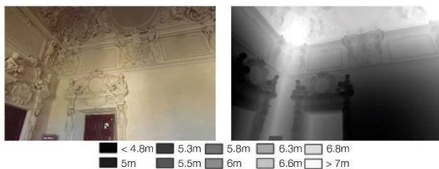
Figura 9. Esempio di immagine generata dal software ScanToSolidRGBDImage nella visualizzazione RGB e indicazione delle profondità.
