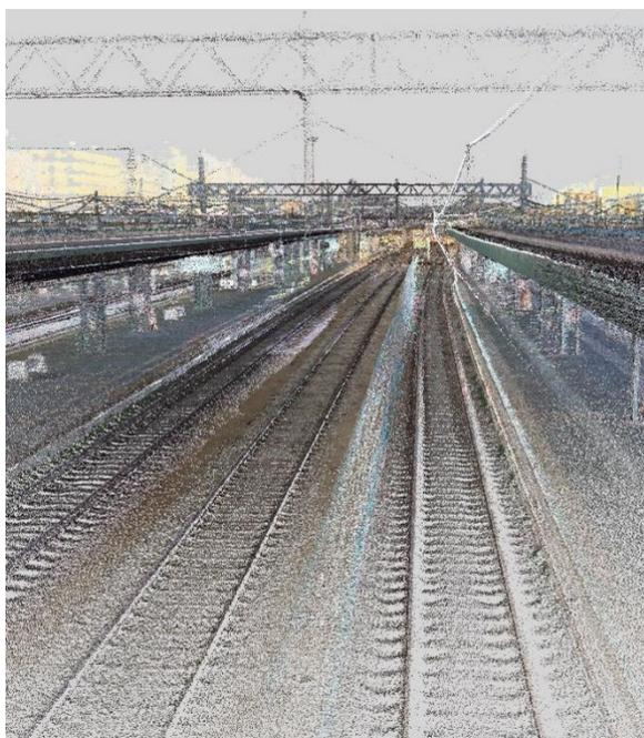
Figura 2 - Nuvole di punti da laser scanner telemetrico montato su treno
