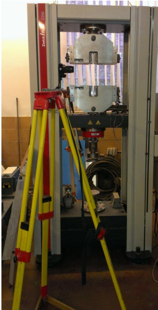
Figura 6. Setup sperimentale: macchina a trazione e camera Canon EOS 1200D
