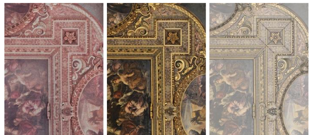
Figura 12. A sinistra: ortofoto laser scanning; in centro: ortofoto fotogrammetrica; a destra: restituzione vettoriale
