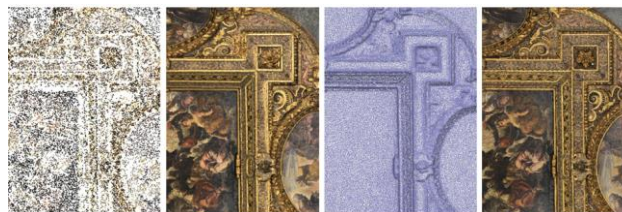
Figura 7. Le differenti fasi di elaborazione in Photoscan. Da sinistra: la nuvola sparsa, la nuvola densa, la mesh e la texture
