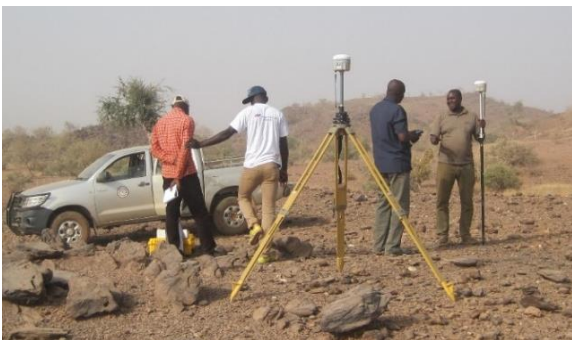
Figura 1. Una delle stazioni Master durante il rilievo
