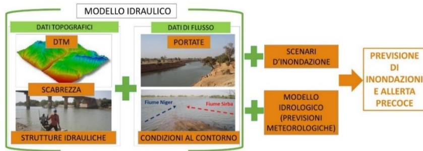
Figura 2. Struttura del sistema di allerta precoce. Il DTM del letto del fiume generato con il rilievo di febbraio 2018 con ricevitori GNSS congiuntamente ai dati di flusso generano il modello idraulico dell'area in esame
