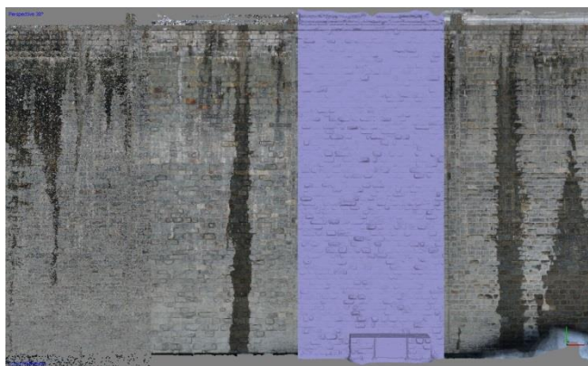
Figura 6. Comparazione tra nuvola sparsa, nuvola densa, mesh e mesh texturizzata
