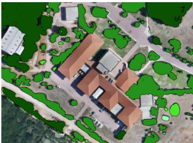
Figura 15. Classificazione in base al valore medio di quota interno a ogni poligono in ambiente QGIS
