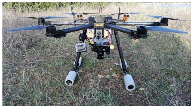
Figura 5 Sistema utilizzato per effettuare il rilievo descritto, un drone FlyNovex equipaggiato da fotocamera Sony r7II FF.
