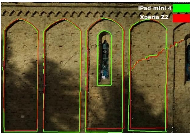
Figura 10. Estrazione di elementi architettonici dalle ortoimmagini di facciata ottenute dal processo fotogrammetrico.
