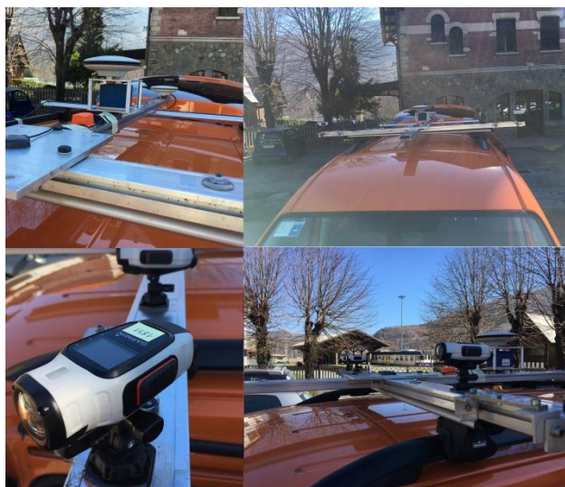
Figura 7. Sistema Ekinox2-D utilizzato per il rilevamento GPS/GNSS ( https://www.sbg-systems.com/ )
