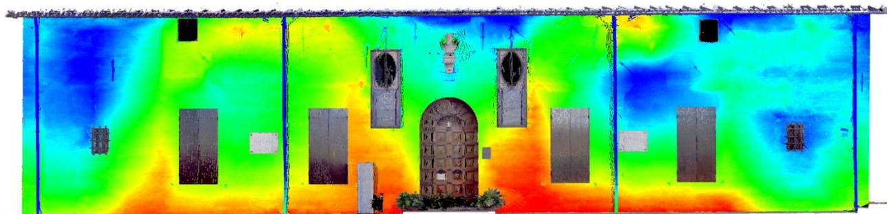
Figura 8. Mappa cromatica delle anomalie geometriche presenti sul prospetto principale del Mauriziano.
