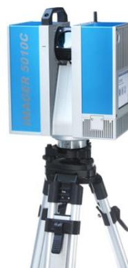
Figura 4. Laser scanner distanziometrico a differenza di fase Z+F Imager 5010C.
