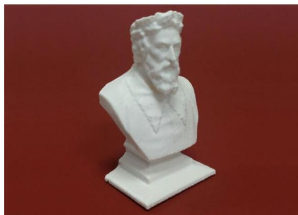
Figura 13. Realizzazione in ABS mediante stampa 3D del busto di Ariosto.
