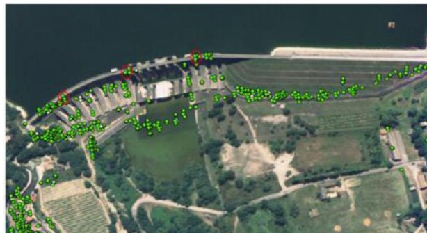
Figura 11. Velocità medie di punti sulla diga ottenute da analisi su immagini COSMO SkyMed.
