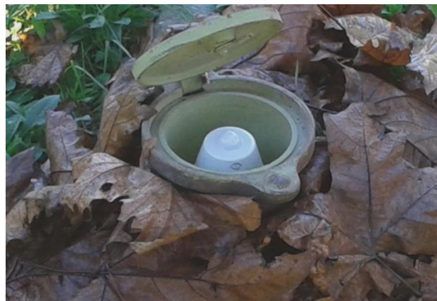
Figura 1. Caposaldo Orizzontale a pozzetto utilizzato per la materializzazione dei capisaldi a partire dal 1941.
