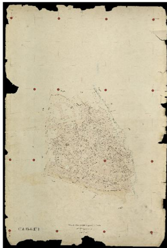
Figura 5. GCP per una trasformazione di 2° e 3° grado
