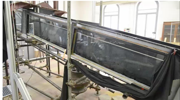
Figura 6. Il canale utilizzato per la simulazione del fenomeno delle colate detritiche inerziali per la
