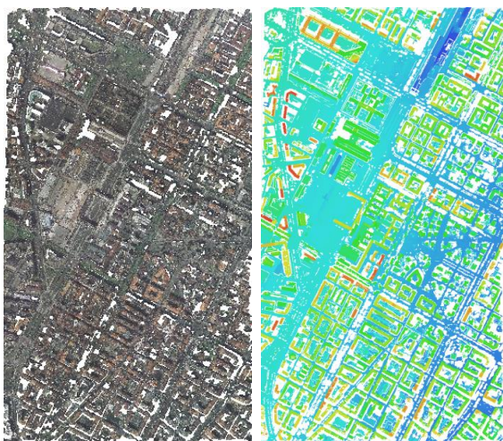
Figura 3. Nuvola di punti (a sinistra) e DSM (a destra) ottenuti con PhotoScan
