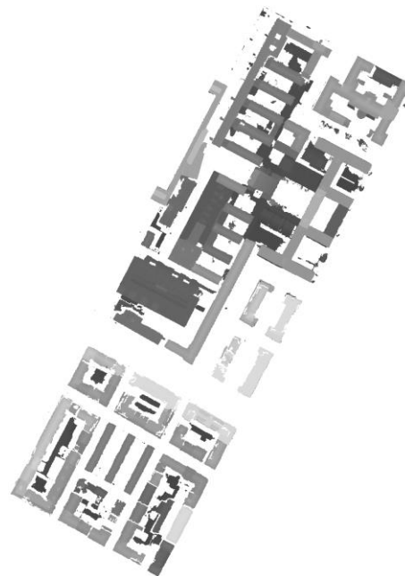
Figura 8. DSM ottenuto dalla combinazione dei risultati derivati dalle elaborazioni eseguite sulle diverse tonalità
