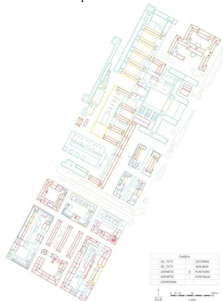
Figura 2. Vettoriale 3D ottenuto tramite restituzione manuale in Z-Map
