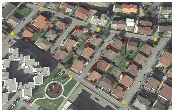
Figura 3. L'area residenziale scelta per lo svolgimento del test cinematico. I GCPs estratti dalla cartografia sono raffigurati in rosso, mentre le pseudo-osservazioni GPS sono rappresentate in giallo
