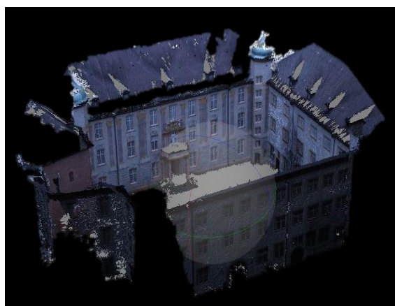
Figura 14. Modello 3D da Dense Matcher con la soluzione di orientamento di EyeDEA (sopra) e da PhotoScan (sotto).
