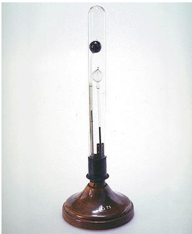
Figura 8. Lucimetro di Leslie (Gabinetto di Fisica di Volta – Università di Pavia)
