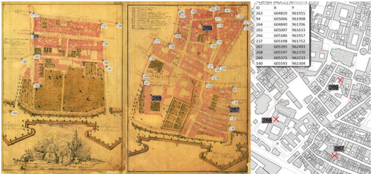
Figura 3. Individuazione dei punti di legame tra le tavole (bianco) e dei GCP (grigio), sulle tavole XVI e XVII e sulla CTR del comune di Parma per consentire la georeferenziazione delle tavole.
