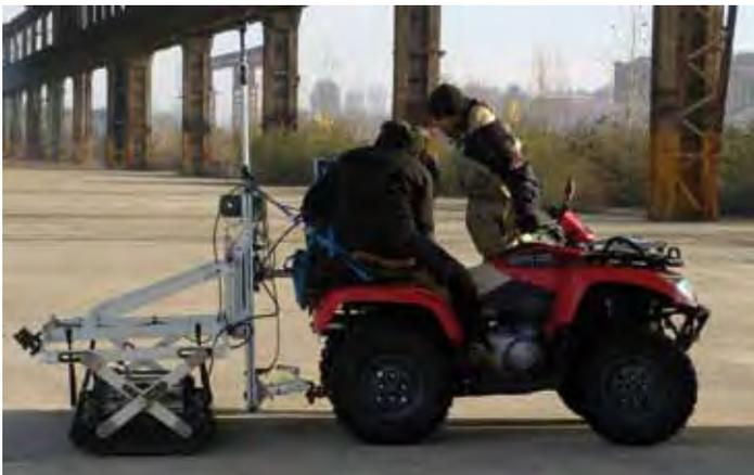
Il GPR non è in grado, da solo, di fornire alcuna informazione circa la sua posizione: proprio per questa ragione esso deve essere necessariamente affiancato da uno strumento di navigazione. Per garantire una corretta ricostruzione tridimensionale degli oggetti interrati indagati, l'antenna georadar deve essere georeferenzata (non necessariamente in tempo reale) con una precisione planimetrica di 20-30 centimetri.
