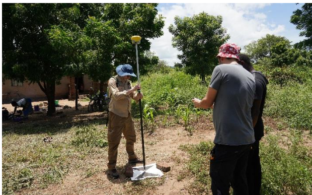
Figura 4. Rilievi GNSS per l'acquisizione dei GCPs nel distretto di Nsanje.
